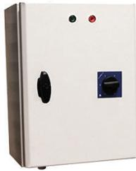
Trasformatore per motori AC trifase. I relè termici sono collegati al conduttore termico prolungato del motore. VRTT interrompe la corrente quando il motore si surriscalda (si resetta quando il motore si è raffreddato e l'interruttore è in posizione 0. Il controller è racchiuso in un alloggiamento in acciaio resistente.
