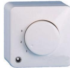
Regolatore di velocità per motori EC, posizioni 0-3 con posizione OFF. Questi regolatori convertono la tensione in uscita (10 V) in tre stadi per ottenere una posizione minima, media e massima. Le posizioni 1 e 2 possono essere adattate ai requisiti ambientali mediante viti. MS EC è certificato e approvato in conformità alle normative su sicurezza e interferenza elettrica in tutti i mercati.
