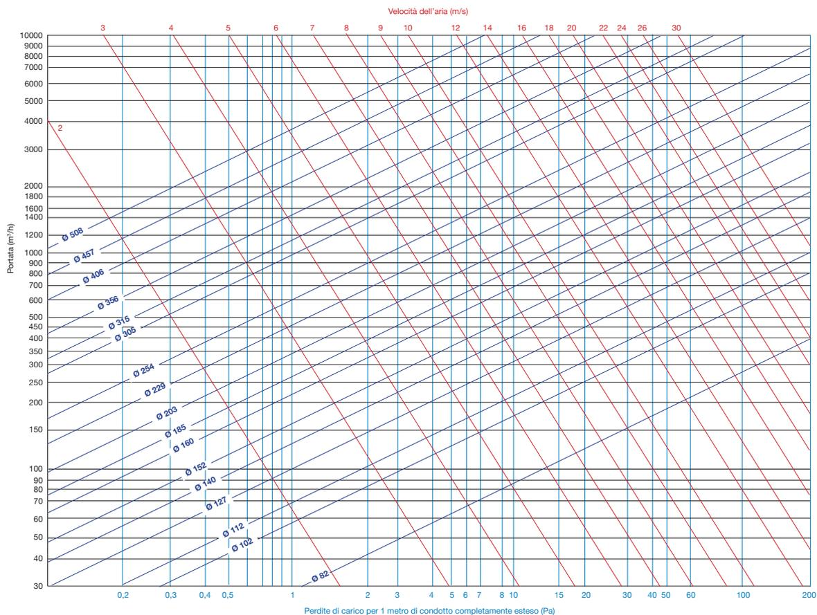
I dati di perdita di carico riportati nel diagramma soprastante sono validi per aria alla temperatura di 20° C. Per temperature diverse utilizzare i seguenti coefficienti correttivi:
