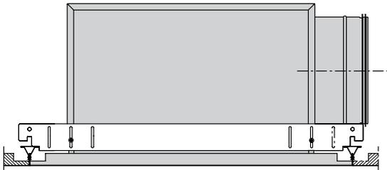
Plenum tipo H con staffa di montaggio tipo PBB.
