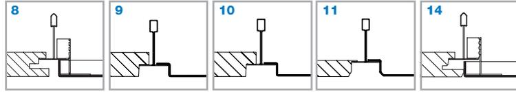
Struttura mascherata Ecophon Focus DG      Struttura a T (24 mm) Pannelli a semincasso      Struttura a T (15 mm) Pannelli semincasso      Struttura a T (24 mm) Pannelli sporgenti Danotile Markant      Ecophon Focus DS
