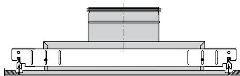
Plenum tipo V con staffa di montaggio tipo PBB
