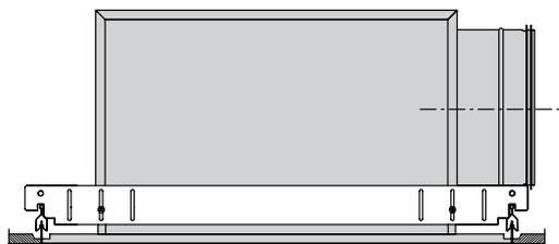
Plenum tipo H con staffa di montaggio tipo PBB
