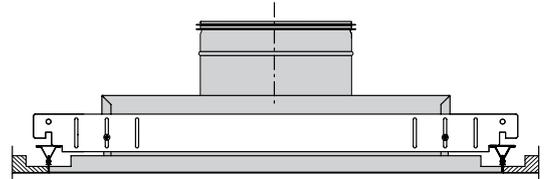
Plenum tipo V con staffa di montaggio tipo PBB.
