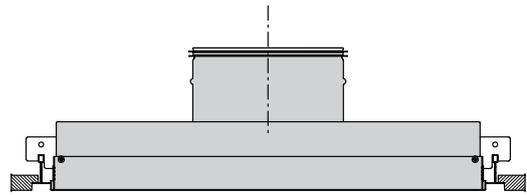
Plenum tipo V con staffa di montaggio tipo PBB
