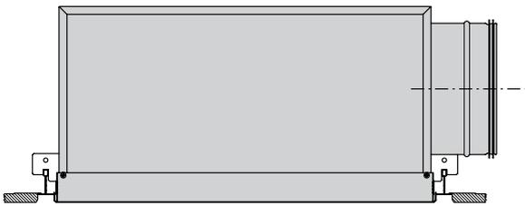
Plenum tipo H con staffa di montaggio tipo PBB.
