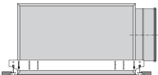
Plenum tipo H con staffa di montaggio tipo PBB.
