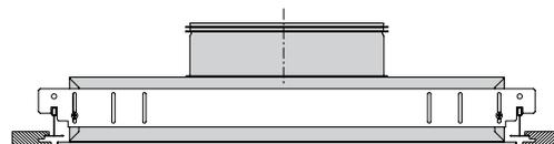
Plenum tipo V con staffa di montaggio tipo PBB.
