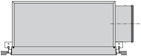
Plenum tipo H con staffa di montaggio tipo PBB
